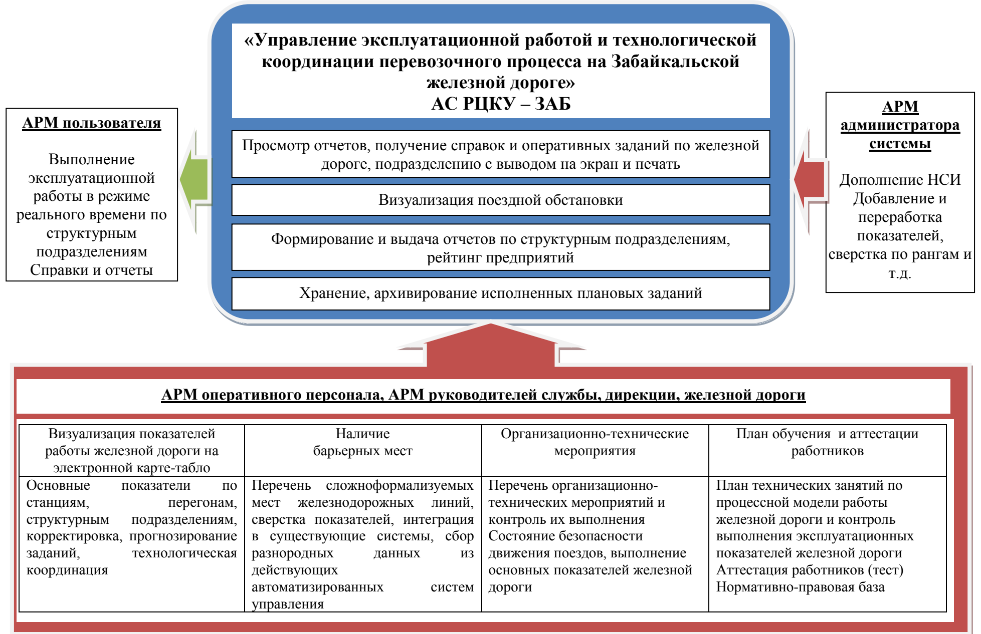
Рисунок 4.8 – Организационно-функциональная схема АС РЦКУ – ЗАБ
